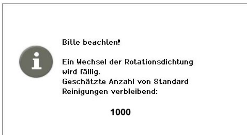
Abb. 10.2.1.1 Displayanzeige Rotationsdichtung wechseln
