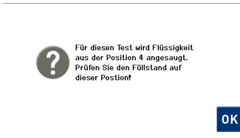
Abb. 10.3.2 Displayanzeige Füllstand Medienbehälter #4 prüfen
