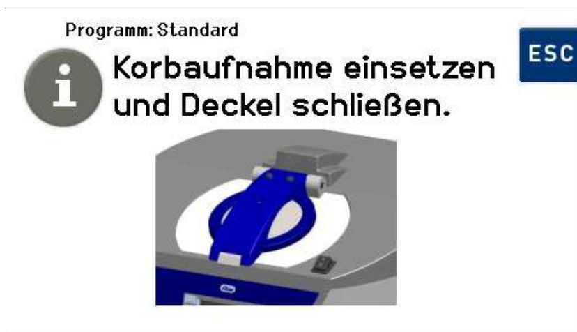
Abb. 6.3.2 Displayanzeige Korbaufnahme einsetzen – Deckel schließen
