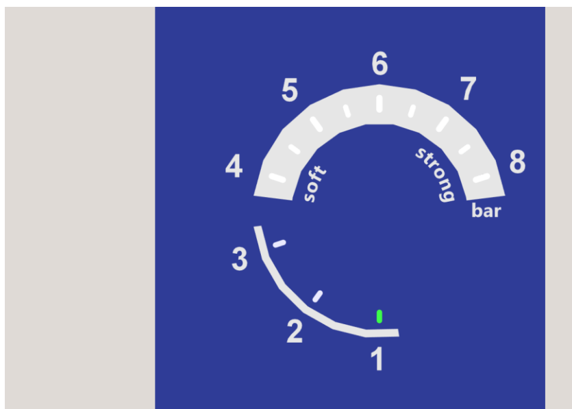
Bild 7.4.5.2: Manometer Anzeige Entkalkungsschritte 1-8
